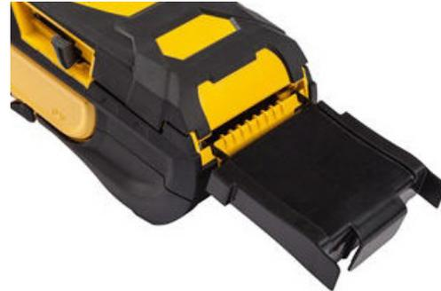
5. Inserire il core per la Stampante per etichette M610 (con il chip rivolto verso sinistra) all'interno della stampante. Regolare la guida del consumabile in base alle necessità.
