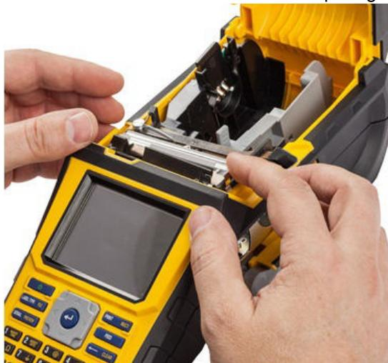
2. Sostituire la lama o pulirla con un bastoncino preinumidito del kit di pulizia Brady PCK-6.
